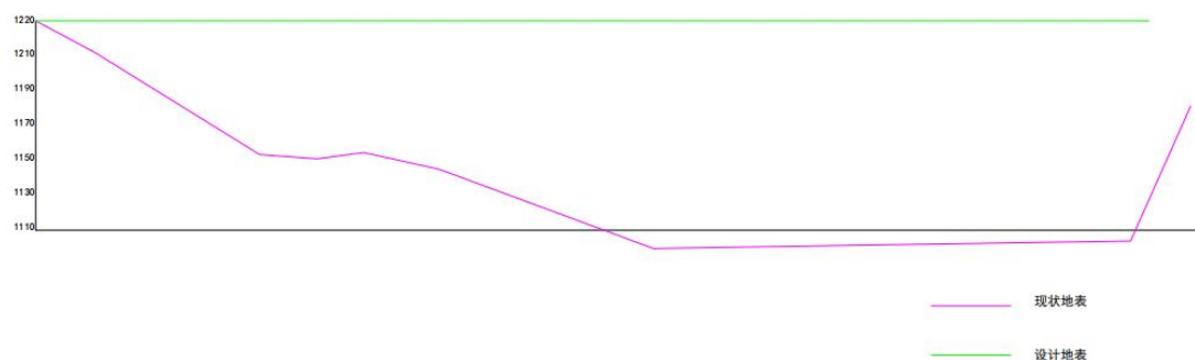
图3.2-3 治理区回填剖面示意图
