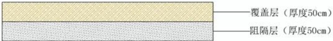
图 3.3-12 封场覆盖结构示意图
