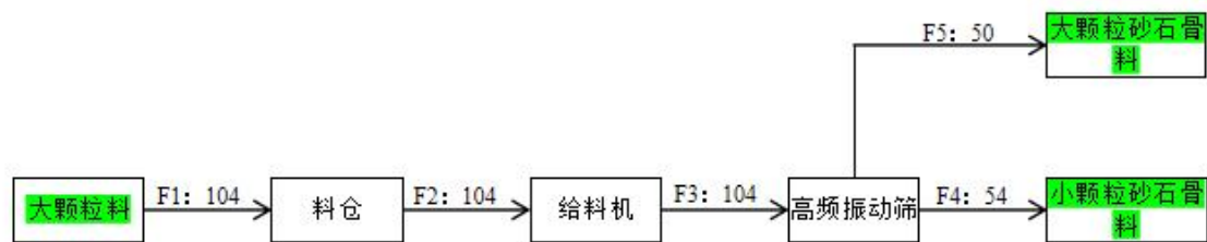
图2.4 项目砂石骨料生产物料平衡图（单位：万t/a）
