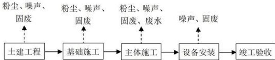
图2-3 施工期施工流程及主要污染源情况简图
