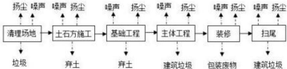
图 2-3 施工期工艺流程及排污节点图
