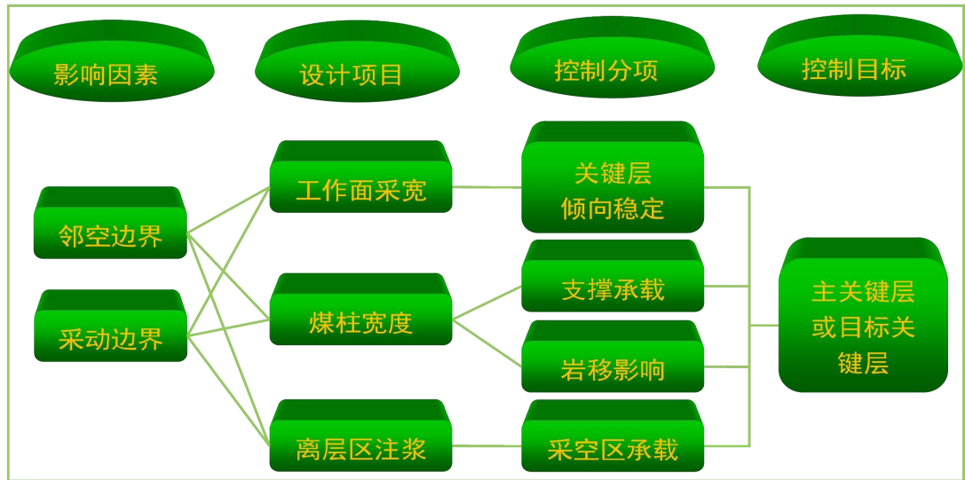
图 2-5 离层注浆控制设计原理框图
