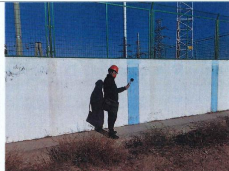
高头窑110kV变电站南侧围墙噪声检测
