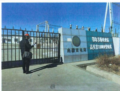
高头窑110kV变电站大门处噪声检测
