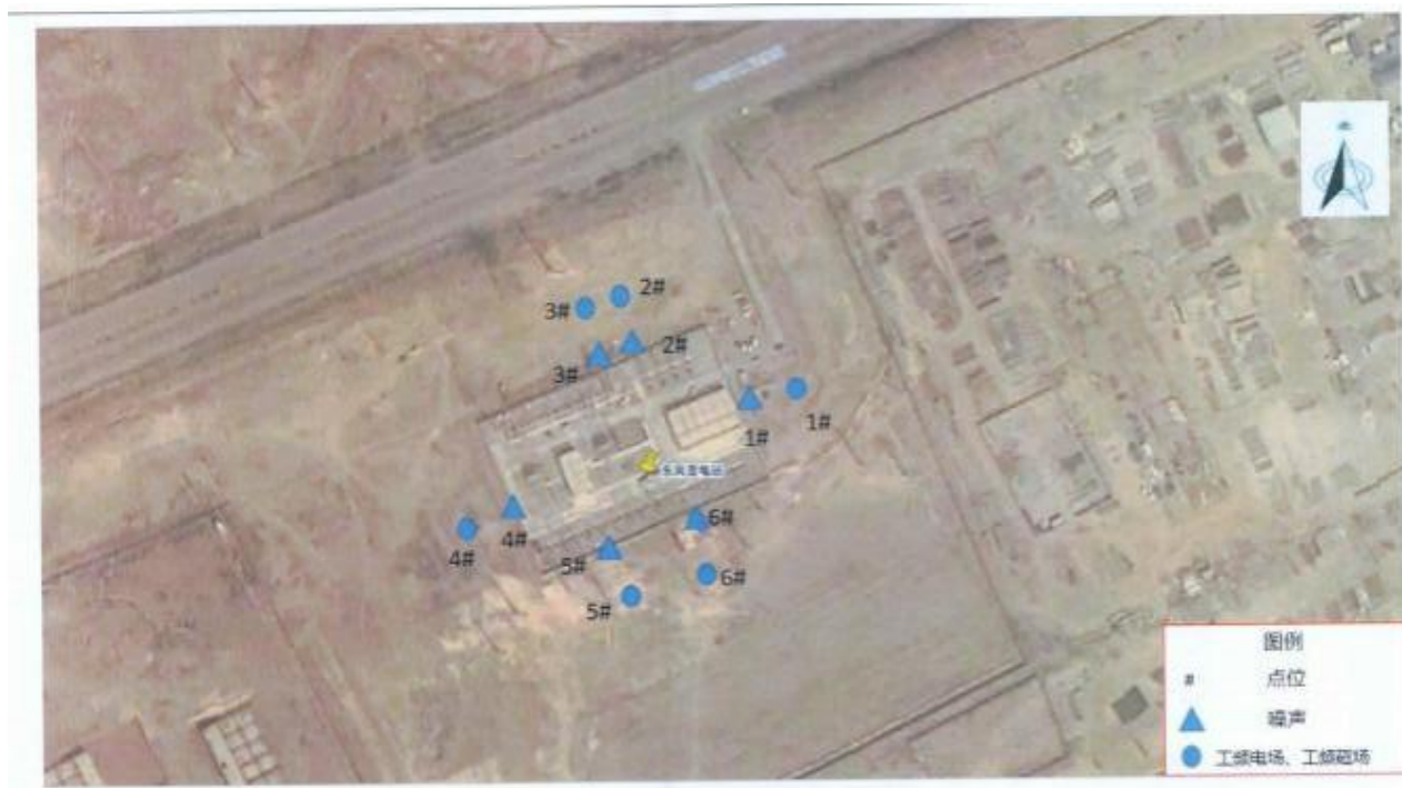
图 6.1-1 乌海东风 220 千伏变电站监测布点图
