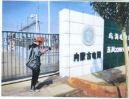
东风变电站大门口噪声检测
