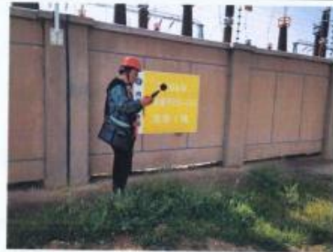
东风变电站北围墙外噪声检测
