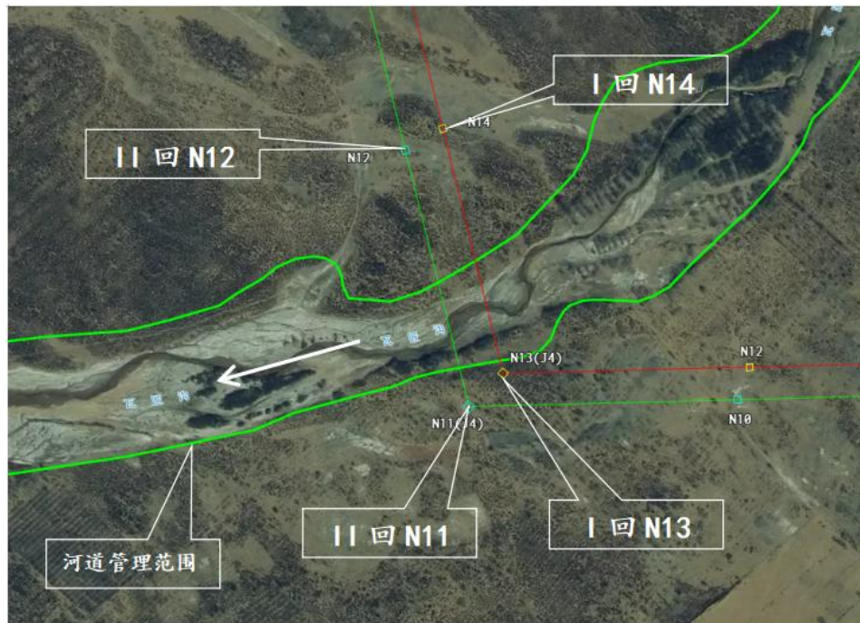
图 2.1-2 瓦匠沟跨越段铁塔布置图
